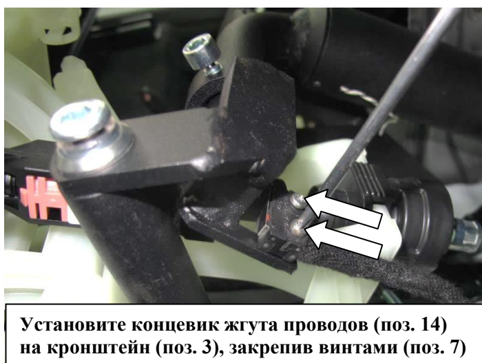
Соедините разъем замка (поз. 1) с разъемом жгута проводов (поз. 14)
